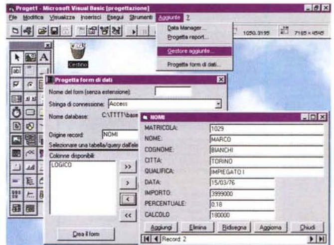
Figura 19 - MS Visual Basic 4.0 - Aggiunta Form Designer. In VB4 viene introdotto un sistema di Aggiunte. La più... carina, tra quelle a disposizione, che è basata anche sul concetto di Classe (di cui parliamo nel testo), è quella che serve per generare un Form di interfaccia ad un RecordSet, completo di tutte le funzionalità per gestire i dati del recordset stesso. Questo può essere una Tabella di un database, oppure un Dynaset, ovvero una tabella virtuale generata con un'espressione SQL.
